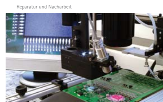
Reparatur und Nacharbeit
