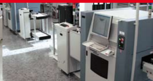
SMD Kontrolle AOI (Automatische Optische Inspektion)
